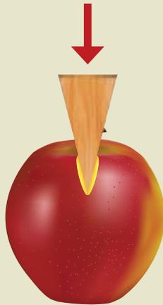
Hay materiales que no se pueden partir fácilmente. Para hacerlo se utiliza una herramienta llamada cuña, que es una máquina simple. Se trata de una pieza de madera o metal en forma de prisma triangular. Una de sus aristas es filosa y se utiliza para dividir cuerpos sólidos.
