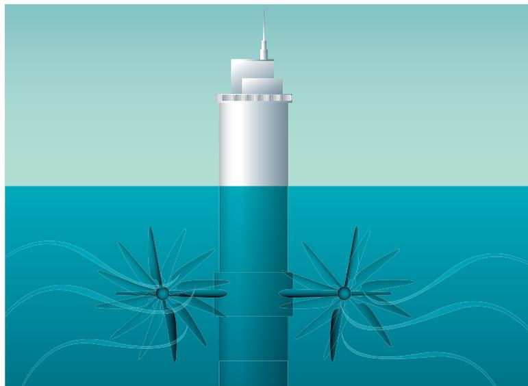
Convertidor de energía oceánica. La fuerza de las corrientes rota el convertidor y genera electricidad. Las turbinas oceánicas son más confiables que las de viento, ya que el cambio de marea es constante y predecible.
