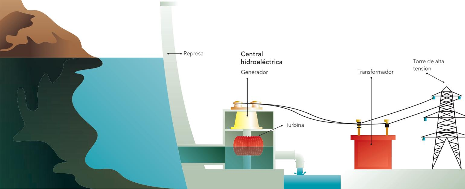
Otros tipos de centrales generadoras de energía son la hidroeléctrica, la eólica y la nuclear.
